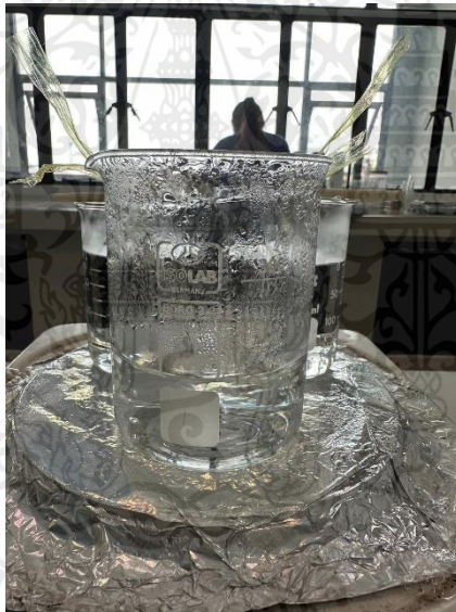
ต้มแผ่นอลูมิเนียมกับน้ำเดือด 2 ชั่วโมง
