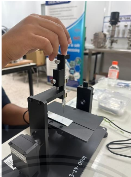
หยดน้ำลงบนแผ่นอลูมิเนียมเพื่อทำการวัดและบันทึกค่า
