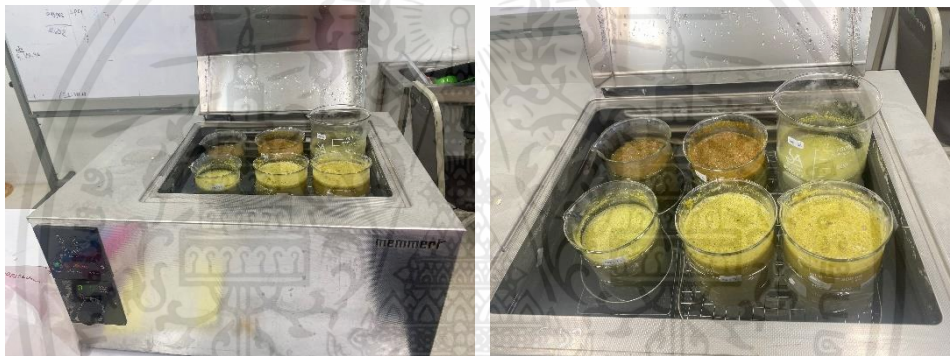
รูปที่ ก.6 สกัดในอ่างควบคุมอุณหภูมิ ที่อุณหภูมิ 60 70 และ 80 องศาเซลเซียส
