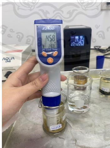
รูปที่ ก.13 การวิเคราะห์ค่าความเป็นกรด-ด่าง ด้วยเครื่อง pH meter (EZDO, 7200, China)
