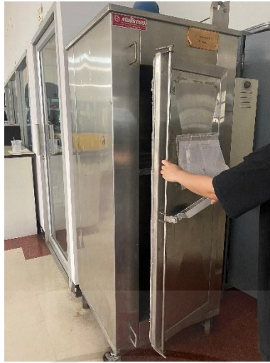
รูปที่ ก.3 นำเปลือกมะม่วงมาอบที่ตู้อบลมร้อนแบบกด 60 องศาเซลเซียส 6 ชั่วโมง
