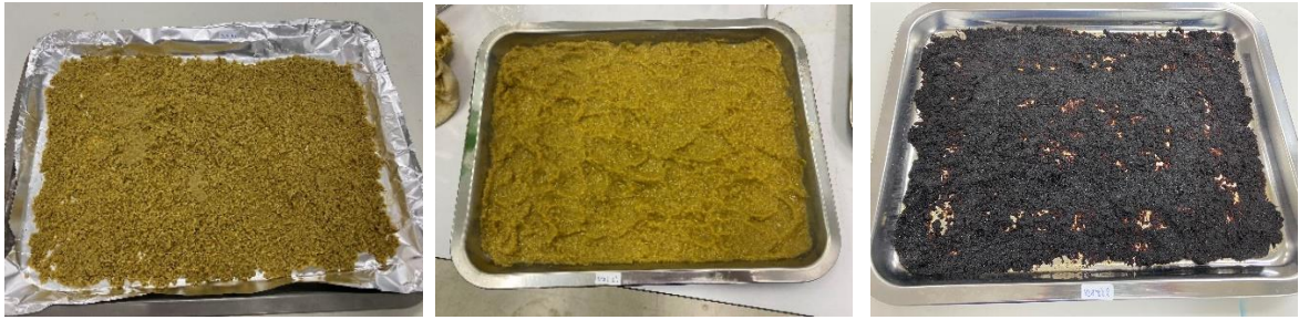
รูปที่ ก.8 ส่วนที่ไม่ผ่านการกรองไปอบที่ตู้อบลมร้อน 55 องศาเซลเซียส 48 ชั่วโมง
