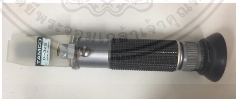
รูปที่ 3.11 Refractometer ยี่ห้อ Atago 0 - 32 %Brix
