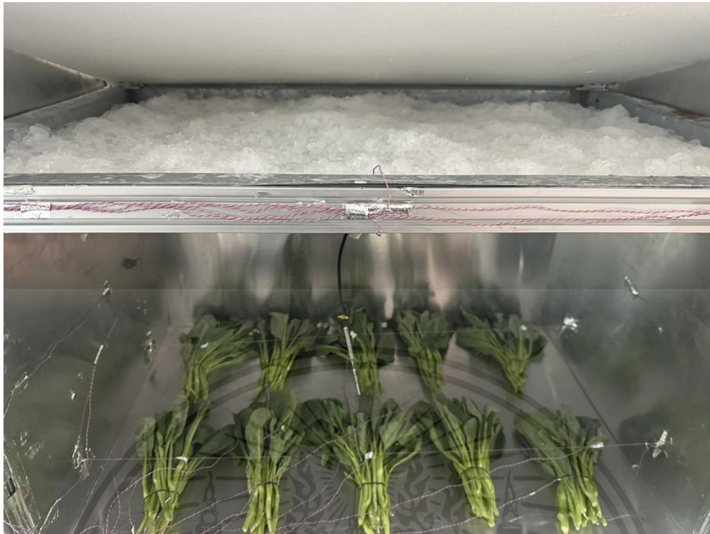
รูปที่ ก-3 ถาดใส่กึ่งสารรับน้ำแข็งที่เป็นตัวให้ความเย็น
