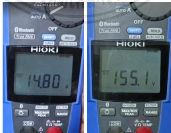
รูปที่ 4.12 กระแสและแรงดันขาเข้าของแหล่งจ่าย
