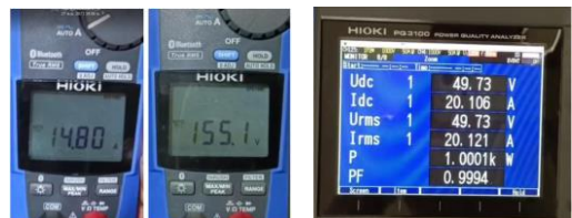
รูปที่ ก.13 กระแสและแรงดันขาเข้าของแหล่งจ่าย และ แรงดันขาออก ( U_{dc} ) และ กระแสขาออก ( I_{dc} )
