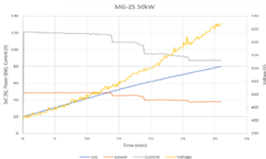
รูปที่ 3 โปรไฟล์การชาร์จรถยนต์ไฟฟ้ารุ่น MG-ZS ที่ตู้ขนาด 50 kW
