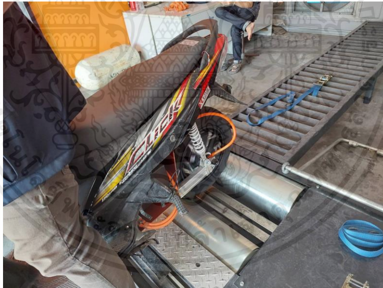
รูปที่ 4.4 การจัดวางล้อเพื่อทดสอบ
