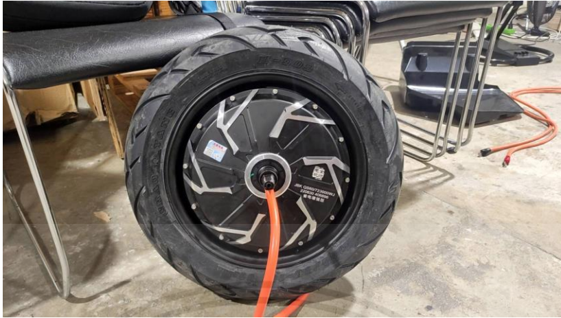
รูปที่ 3.4 มอเตอร์ไฟฟ้าพิกัด 3000 W 96 V
