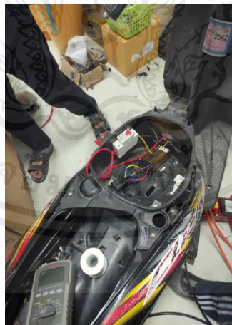
รูปที่ 3.24 ตำแหน่งของ DC-DC Converter โดยต่อเข้าระบบไฟแล้ว
