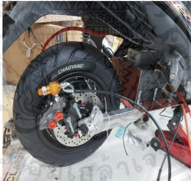
รูปที่ 3.19 มอเตอร์ไฟฟ้ากระแสตรงชนิดไร้แปรงถ่าน (Hub Motor) และ Swing Arm
