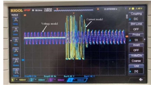
รูปที่ 6 ผลการทดลองแสดงรูปคลื่นพลาซึ่มที่เกี่ยวข้องที่สเตเตอร์โดยแบบจำลองกระแสและแบบจำลองแรงดันภายใต้การสตาร์ทตรง
