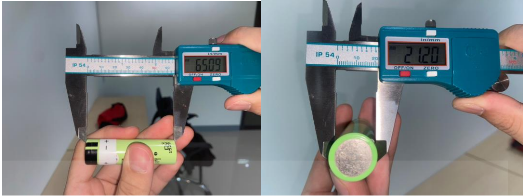
รูปที่ 3.6 ขนาดของแบตเตอรี่รูปทรงกระบอกชนิด NCR ขนาด 21700
