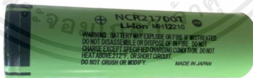
รูปที่ 3.2 แบตเตอรี่รูปทรงกระบอกชนิด NCR ขนาด 21700
