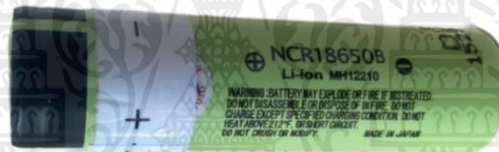
รูปที่ 3.1 แบตเตอรี่รูปทรงกระบอกชนิด NCR ขนาด 18650
