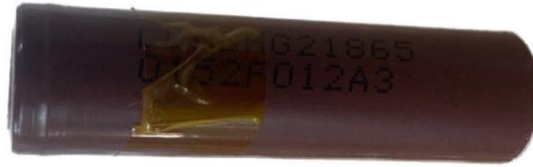
รูปที่ 3.3 แบตเตอรี่รูปทรงกระบอกชนิด INR ขนาด 18650
