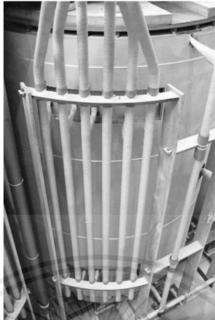
รูปที่ 2.7 การพันสายในหม้อแปลงไฟฟ้าด้วย Crêped paper [1]
