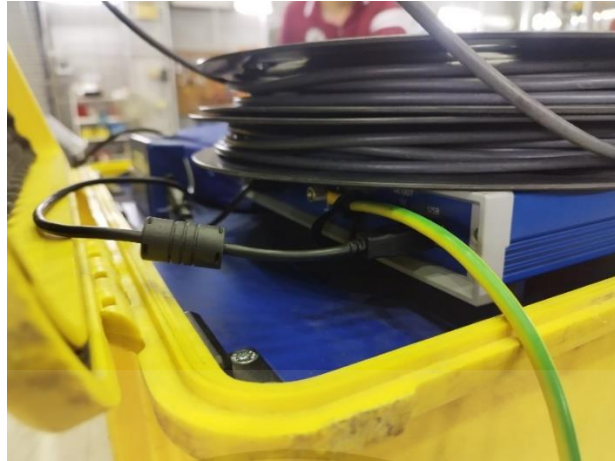
รูปที่ 3.7 กราวด์ของเครื่องมือวัด DIRANA
