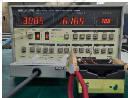
รูปที่ 3.12 การวัดค่าความเหนี่ยวนำของหม้อแปลงความถี่สูงที่ออกแบบสร้าง (ก) หม้อแปลงตัวที่ 1
