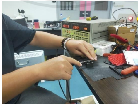
รูปที่ 3.7 การตะไบแกนเฟอร์ไรต์เพื่อสร้าง Air gap
