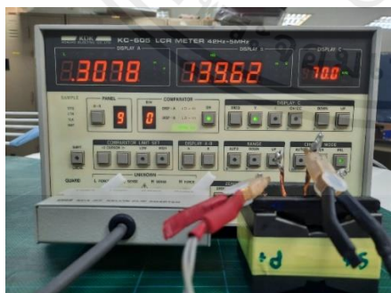
รูปที่ 3.12 การวัดค่าความเหนี่ยวนำของหม้อแปลงความถี่สูงที่ออกแบบสร้าง (ก) หม้อแปลงตัวที่ 1
