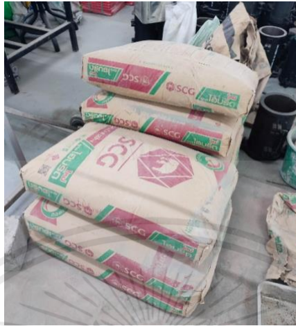
รูปที่ 3.7 ปูนซีเมนต์พอร์ตแลนด์ประเภทที่ 1
