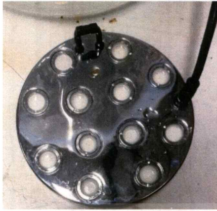
รูปที่ 3.2 ชุดหัวกำเนิดอัลตราโซนิก 12 หัว ชนิด เพียโซอิเล็กทริก 36 โวลต์
