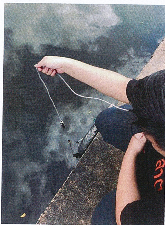
รูปที่ 4.3 ทำการหย่อนเซนเซอร์เพื่อวัดค่าระดับน้ำในคลองสี่
