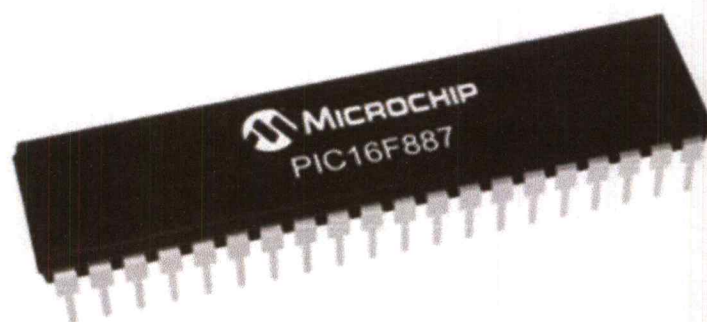
รูปที่ 2.5 รูปภาพแสดงไมโครคอนโทรลเลอร์ PIC
