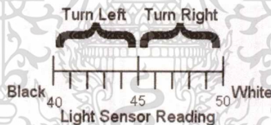
รูปที่ 2.3 ภาพแสดงการแบ่งค่าแสงของเซนเซอร์ออกเป็น 2 ส่วนสัมพันธ์กับการเคลื่อนที่ของหุ่นยนต์ [5]
