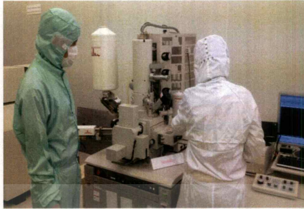
รูปที่ 3.50 เครื่องSEM รุ่น Hitachi S-5200
