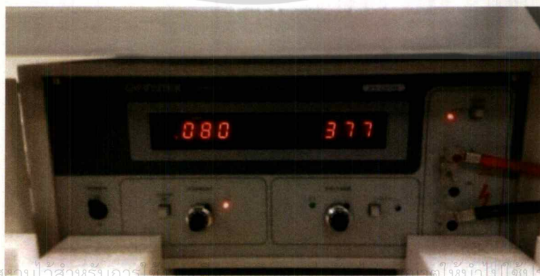
รูปที่ 3.20 แหล่งกำเนิดไฟฟ้ากระแสตรง ยี่ห้อ GW Instek รุ่น GPR-100H05D
