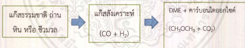
รูปที่ 2.3 กระบวนการผลิตไดเมทิลอีเทอร์แบบทางตรง (Direct DME synthesis)
