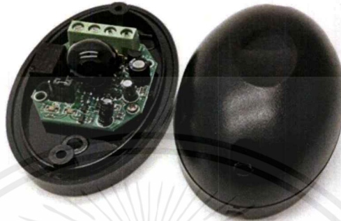
รูปที่ 3.16 อินฟราเรดเซ็นเซอร์ตรวจจับ Infrared Radiation Detector
