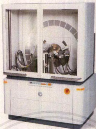
รูปที่ 3.4 เครื่องทดสอบการเลี้ยวเบนของรังสีเอกซ์ [45]
