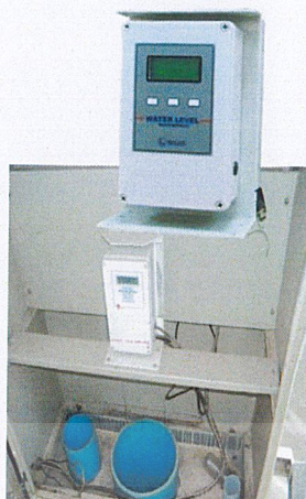
รูปที่ 2.4 เครื่องวัดระดับน้ำแบบอิเล็กทรอนิกส์ชนิดลูกลอย
