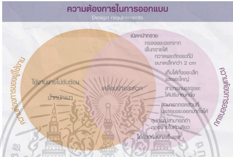
รูปที่ 4.1 ความต้องการในการออกแบบอุปกรณ์เก็บขยะบนชายหาด
