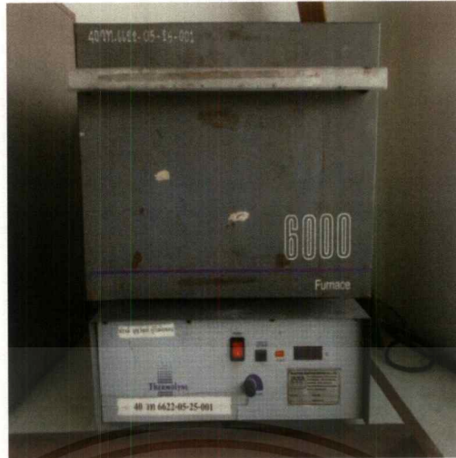
รูปที่ 3.1 แสดงการนำตัวเร่งปฏิกิริยาไปทำการแคลไซน์
