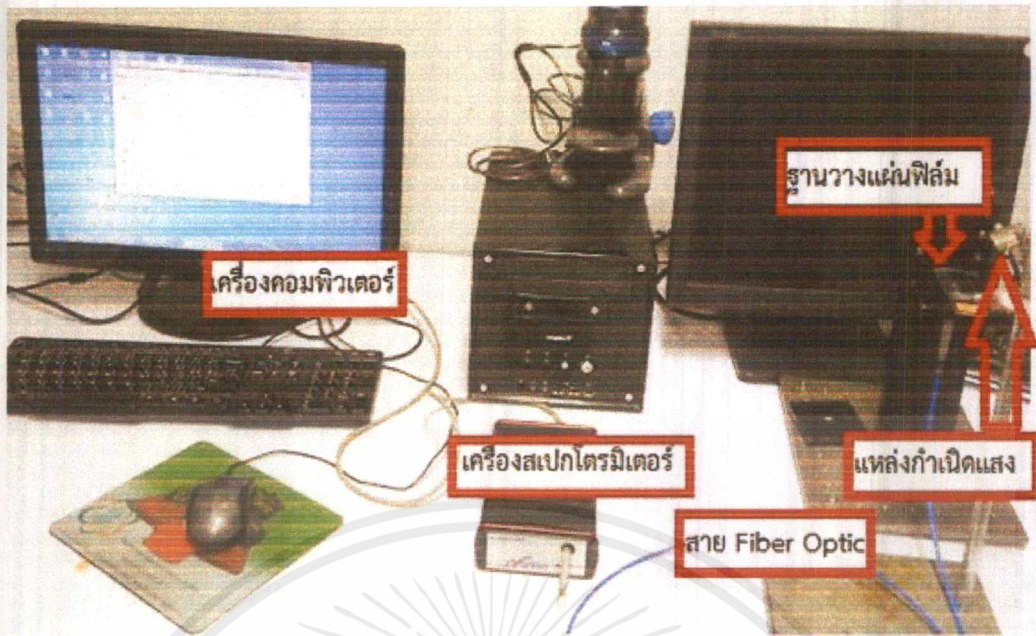
ภาพตัวอย่างการวัด blank สำหรับการวัดการดูดกลืนของสารละลายในคิวเวท
