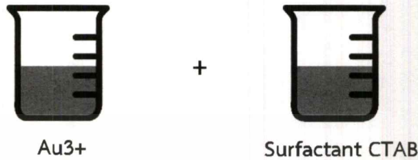
รูปที่ 3.7 ใส่ Surfactant CTAB ในน้ำ 100 ml ลงไปใน Au^{3+}
