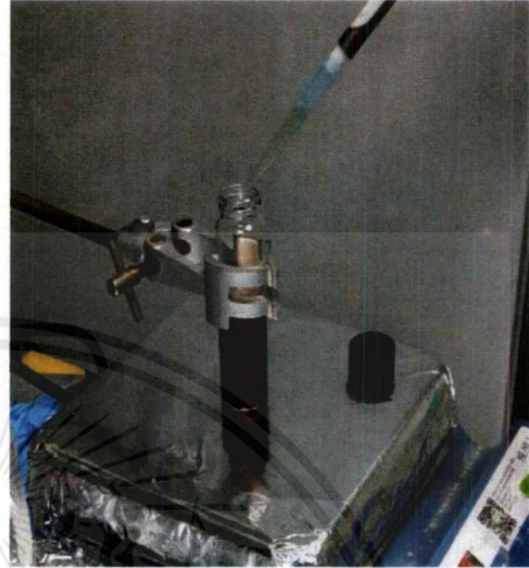
รูปที่ 3.19 ใส่ microgels PNIPAM ที่ concentrate แล้ว 3 เท่า ลงใน gold nanoparticles
