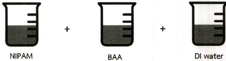
รูปที่ 3.15 ขวดที่ 1 สาร NIPAM กับ BAA ใน DI water
