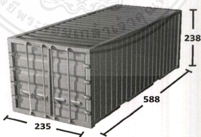
รูปที่ 3.1 ขนาดของตู้คอนเทนเนอร์ (หน่วยเป็นเซนติเมตร)
