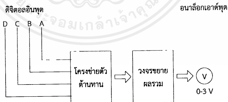
รูปที่ 2.4 แผนภาพกรอบแสดงวงจรแปลงดิจิตอลเป็นอนาล็อก
