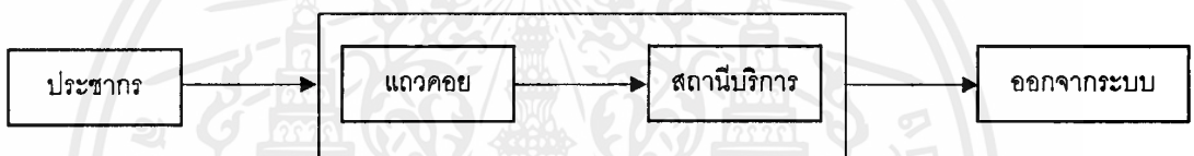
รูปที่ 2.1 โครงสร้างระบบแถวคอย
