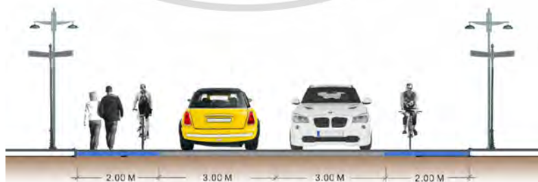
ภาพที่ 2.1 ทางจักรยานแบบใช้พื้นที่ร่วมกับรถยนต์
