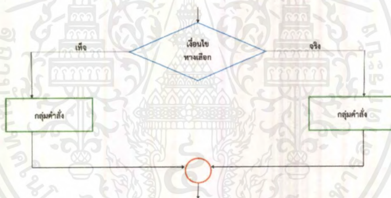
รูปภาพที่ 2.8 ตัวอย่างการเขียนแผนผังการทำงานของโปรแกรมโดยใช้เงื่อนไข if-else
