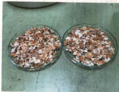
รูปภาพที่ 3.9 บดเป็นชิ้นเล็กเพื่อเตรียม Ball milling
