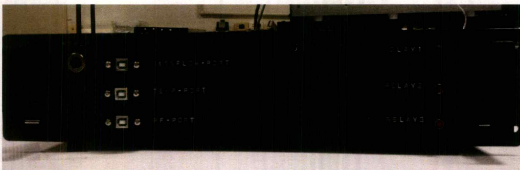
รูปที่ 3.24 ด้านหน้าของเครื่องควบคุมระบบ Rf Magnetron Sputtering
