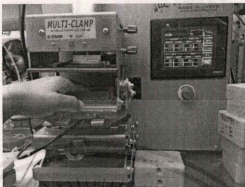
รูปที่ 2.4 การฉีดเทียนโดยเครื่องฉีดเทียน
