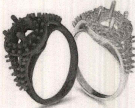
รูปที่ 2.2 แม่พิมพ์แหวนเงิน ที่หล่อจากเรซิน ที่มา : https://i-maker.jp/i/jewelry-resin
