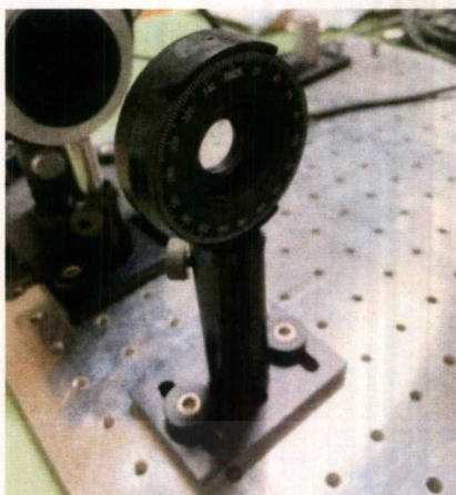
รูปที่ 4.8 มุมของแผ่น Half Waveplate
