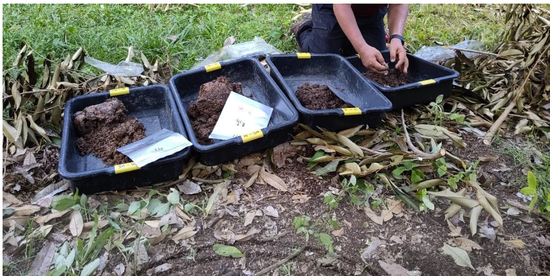
รูปที่ 3.6 การคลุกดินทั้ง 4 จุดมารวมกันเป็น 1 ตัวอย่าง
