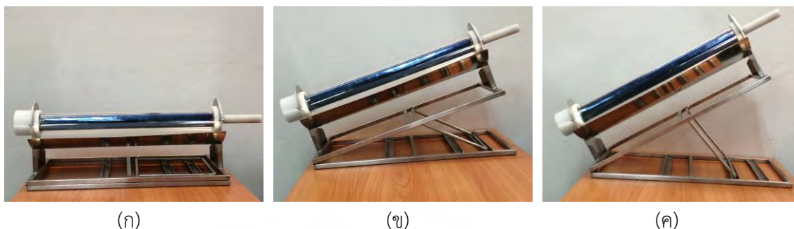
รูปที่ 3.24 เต้าพลังงานแสงอาทิตย์แบบปรับมุมเอียง
