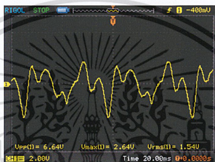
รูปที่ 4.8 ความต่างศักย์ไฟฟ้าของเครื่องกำเนิดไฟฟ้าที่ใช้ฟิล์มพอลิโพรพิลีนขนาด 10 \times 20 \text{ cm}^2 เมื่อกดด้วยความถี่ 20 \text{ Hz}
