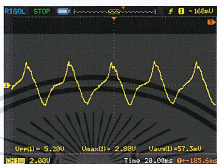
รูปที่ 4.6 ความต่างศักย์ไฟฟ้าของเครื่องกำเนิดไฟฟ้าที่ใช้ฟิล์มพอลิโพรพิลีนขนาด 5\times 7\text{ cm}^2 เมื่อกวดด้วยความถี่ 20 Hz
