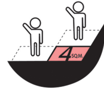
ควบคุมจำนวนคนในการใช้อาคาร ตามเกณฑ์ 4 ตร.ม./คน
