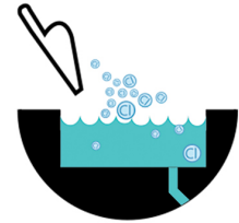
เติมคลอรีนที่บ่อพักน้ำสุดท้าย ก่อนปล่อยน้ำออกสู่สาธารณะ
