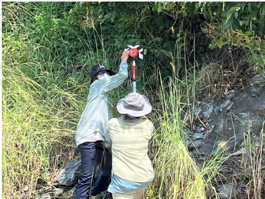
รูปที่ 12 การทำ Profile & Cross section ที่ทางน้ำลงหาดถ้ำพัง
