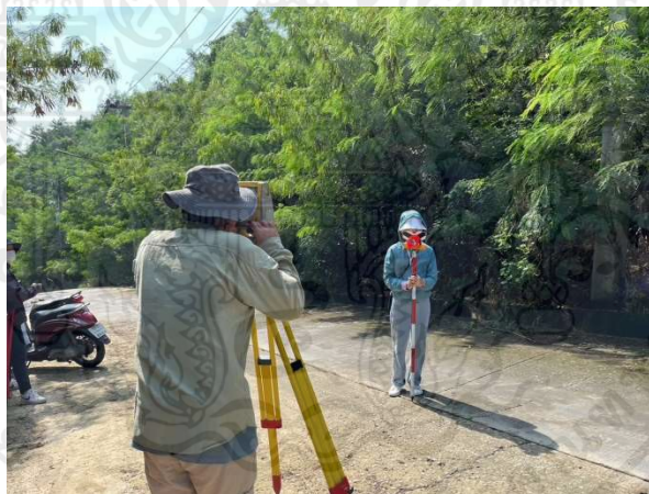
รูปที่ 2. 3 การทำงานระหว่างกล้องประมวลผลรวมกับปริซึมสะท้อนแสง
