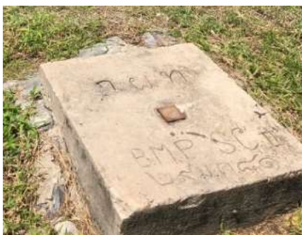
รูปที่ 3. 5 หมุดหลักฐานกรมแผนที่ทหาร BMP SC II
