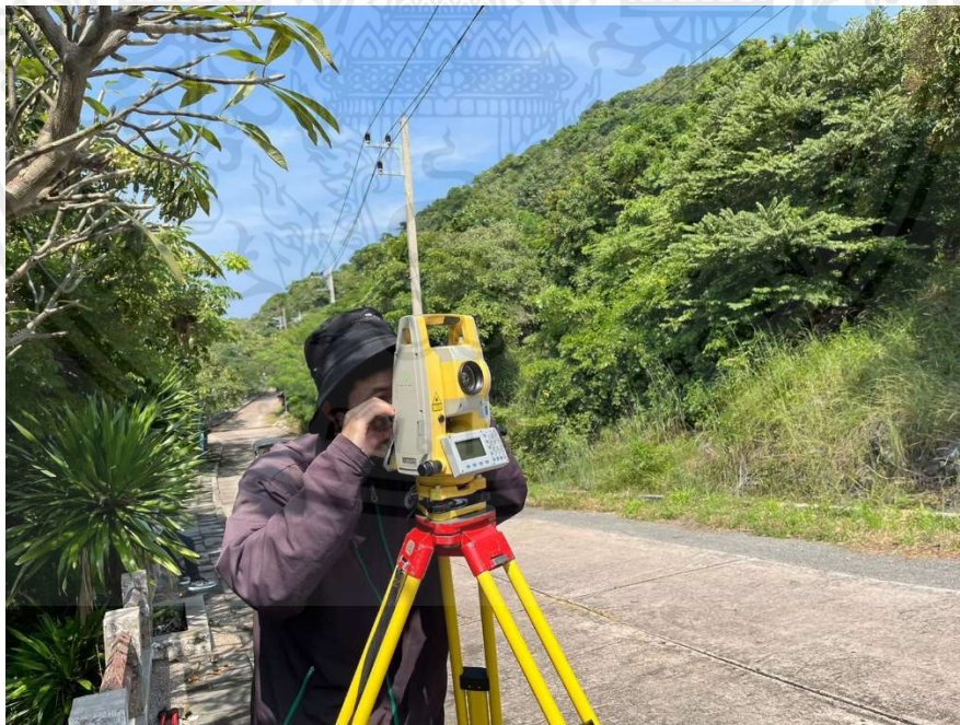
รูปที่ 10 การใช้กล้อง Total station ในการถ่ายระดับทางน้ำลงหาดถ้ำพัง
