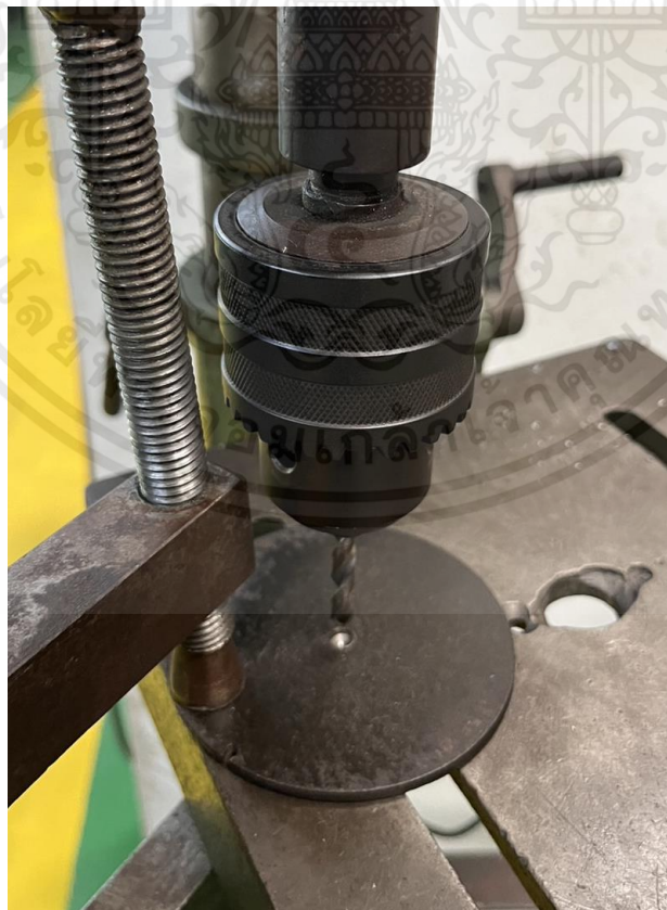
รูปที่ 3.15 การเจาะรูชิ้นส่วนที่ 6
