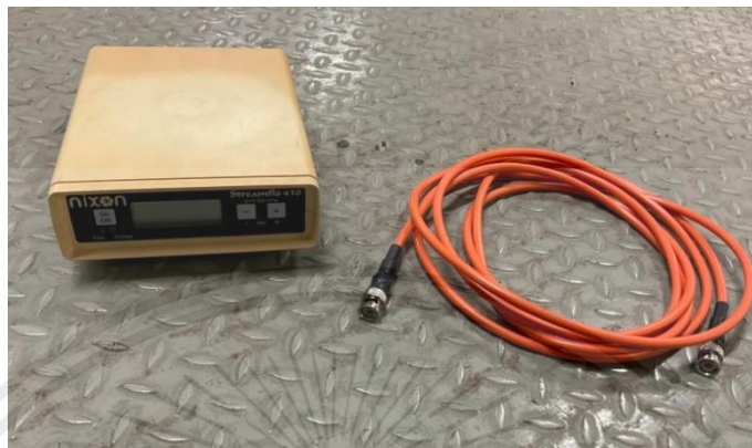
รูปที่ 3.2 เครื่องวัดความเร็ว Nixon Flowmeters ( Streamflo V1.3 4 )
