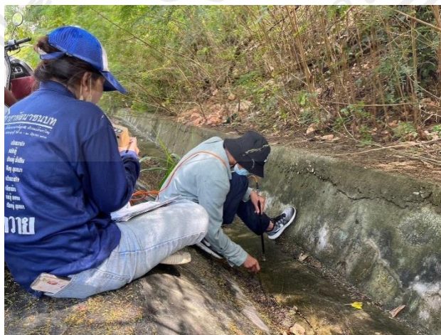
รูปที่ 3.8 การวัดความเร็วน้ำด้วยเครื่อง Nixon Flowmeters(Streamflo V1.3 4)
