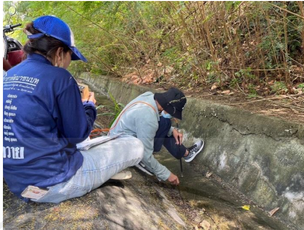
รูปที่ 3.7 การวัดความเร็วน้ำด้วยเครื่อง Nixon Flowmeters(Streamflo V1.3.4)
