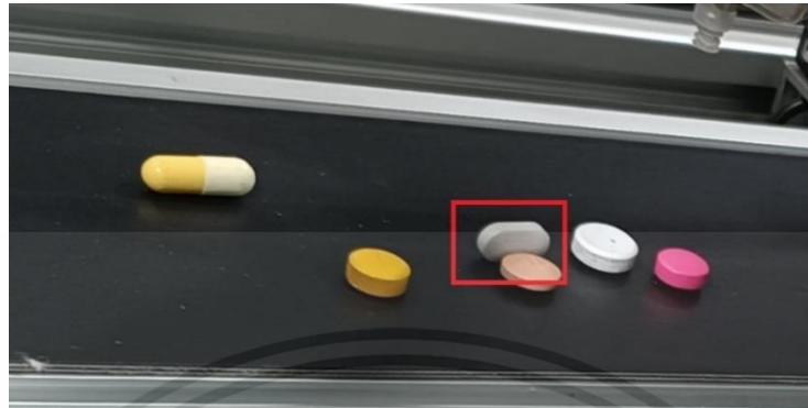
รูปที่ 4.9 ความผิดพลาดของยาชนิด B ที่เกิดขึ้นจากการตั้งออกมาจากตัวปล่อยยา
