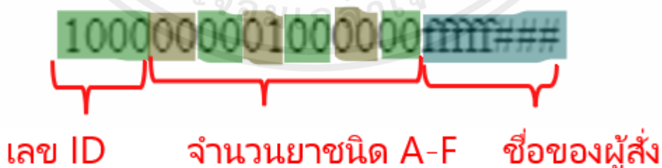
รูปที่ 3.45 รูปแบบการส่งข้อมูลด้วยคิวอาร์โค้ดรีดเดอร์ CF26
