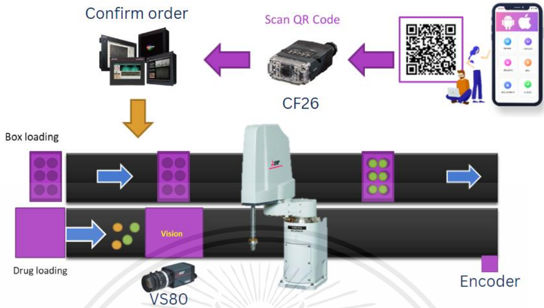
รูปที่ 3.5 การทำงานของชุดสายิตที่ใช้เอ็นโค้ดเดอร์ร่วมกับวิชันเซนเซอร์
