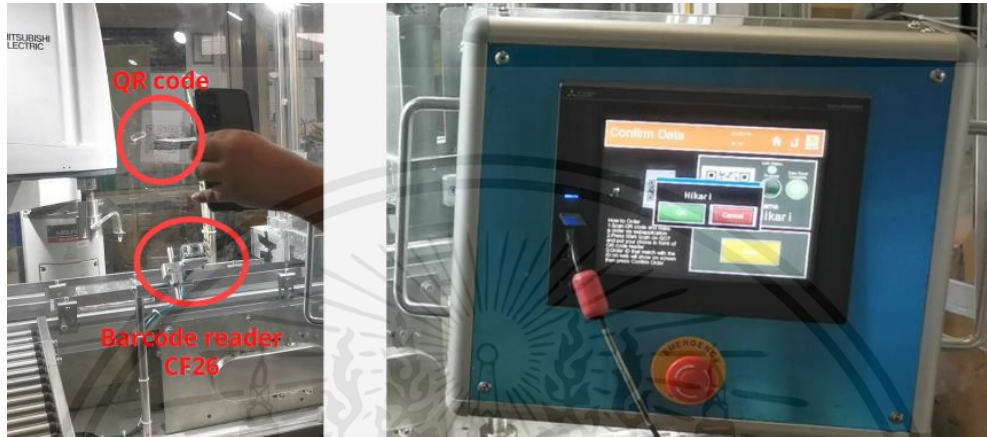
รูปที่ 4.8 GOT เมื่อสแกนคิวอาร์โค้ดได้
