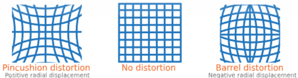
รูปที่ 14 ตัวอย่างรูปแบบการเกิด Distortion
