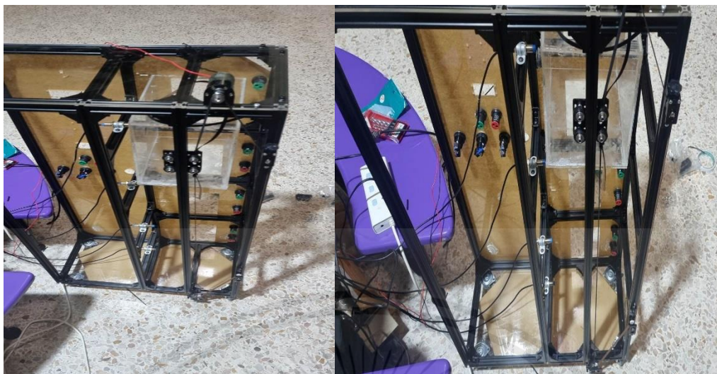
รูปที่ 4.7 การทดลองสั่งการเคลื่อนที่ของลิฟต์ตามคำสั่ง
