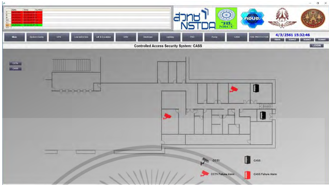
รูปที่ 5.65 การแสดงผลการทำงานของระบบรักษาความปลอดภัย เมื่อกล้องวงจรปิดชำรุด
