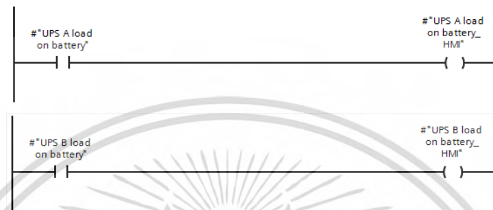
รูปที่ 4.31 ภาษาแลตเตอร์ UPS A และ UPS B ทำงานบนแบตเตอรี่
