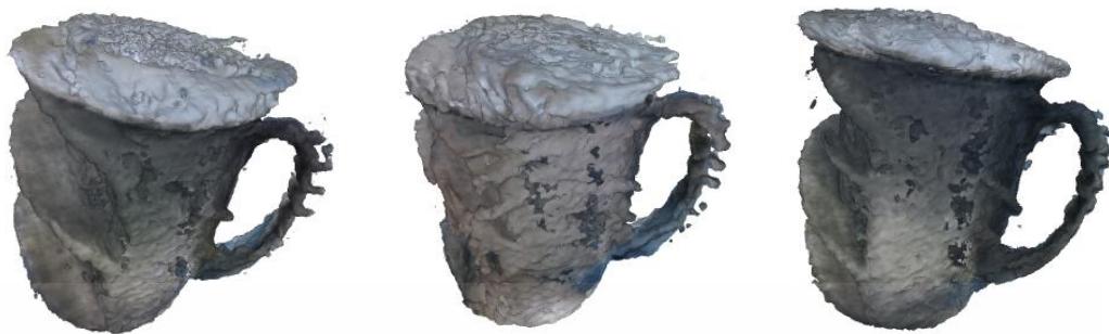
รูป 4.61 ด้านซ้าย CAMERA_MODEL = OPENCV, ตรงกลาง CAMERA_MODEL = PINHOLE ด้านขวา CAMERA_MODEL = RADIAL
