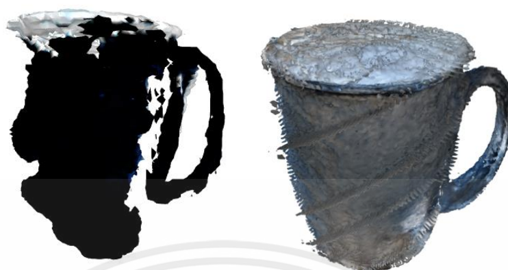
รูป 4.52 โมเดล 3 มิติภาพซ้ำ มี PSNR (7.62) และ SSIM (0.06) น้อยที่สุด ส่วนภาพขวา PSNR (18.19) และ SSIM (0.89) มากที่สุด
