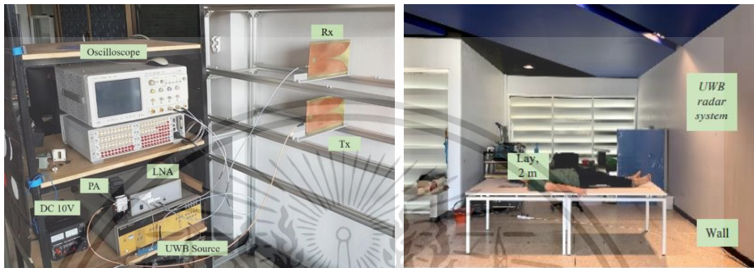
รูปที่ 4.7 การเซตระบบของการตรวจจับการนอนของมนุษย์ที่ ระยะ 2 เมตร
