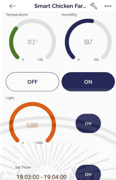
รูปที่ 4.5 นำค่าที่วัดได้มาแสดงผลด้วย Application Blynk
