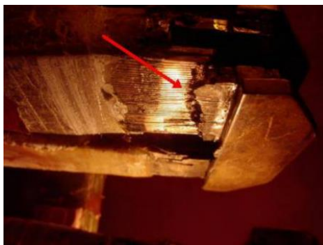
รูปที่ 2.11 รอยแตกเนื่องจากความเครียดทางกลที่บริเวณ endwinding
