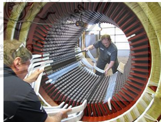
(ข) ขดลวดสเตเตอร์ถูกวางในร่องสลิตของแกนเหล็ก
