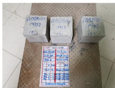
รูปที่ 4.1 ตัวอย่างคอนกรีตบางส่วนหลังการทดสอบกำลังรับแรงอัด
